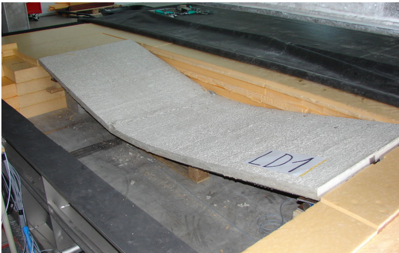
Obr. č. 6 Vzorek spřažené plechobetonové desky po porušení a odkrytí těsnící fólie
