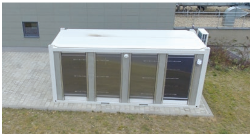
Obr. č. 14 Mobilní experimentální full-scale testovací sestava solárně aktivovaných fasád
