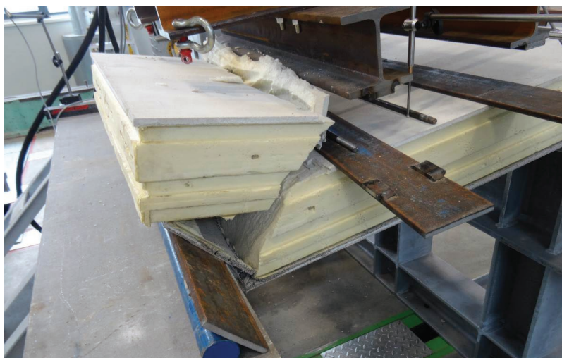
Obr. č. 12 Vzorek po porušení smykem jádra průřezu.
