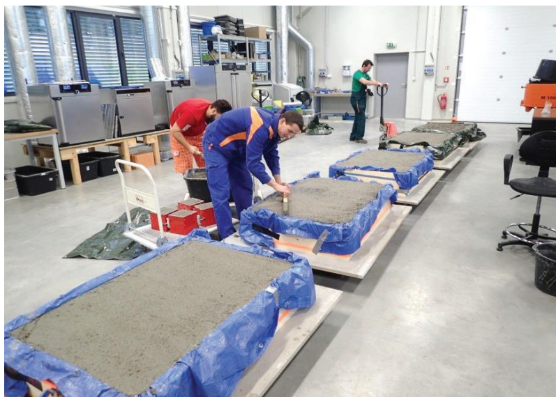
Obr. č. 1 Příprava betonových bloků pro výzkum kotvicích lepidel v rámci projektu TA04010425
