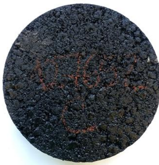
Obr. č. 9 Zařízení pro stanovení součinitele tření po ohlazení (vlevo), zkušební těleso z asfaltové směsi (vpravo)
