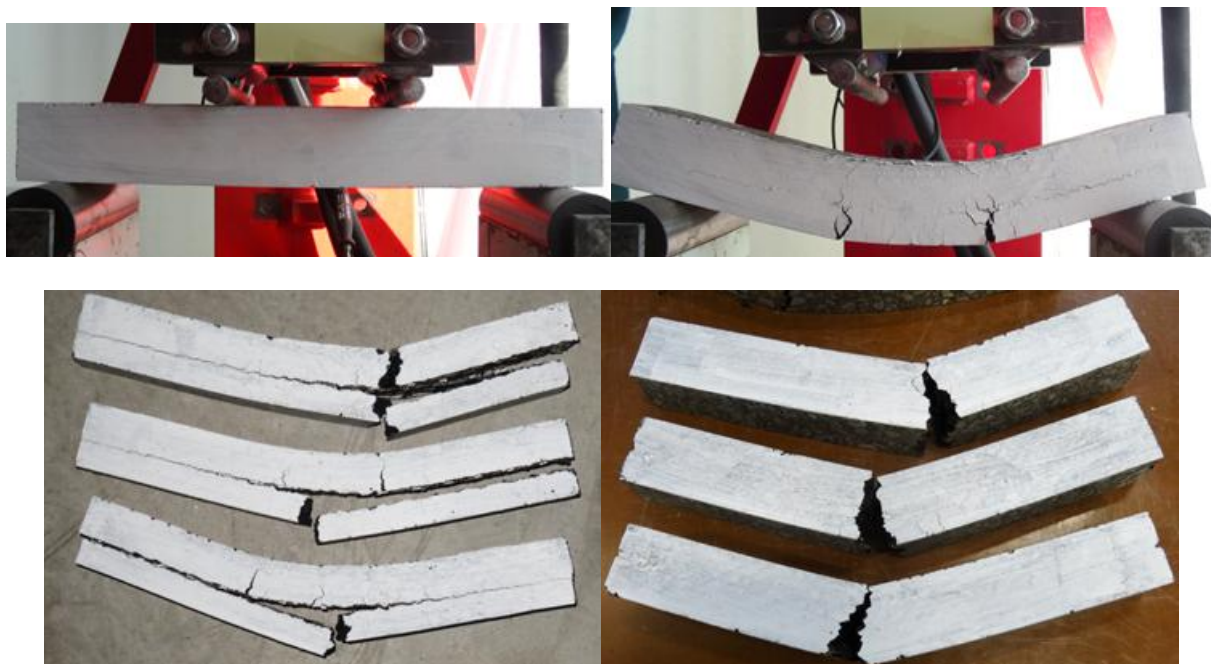
Obr. č. 8 Souvrství se sklovláknitou výztuží (vlevo) a bez výztuže (vpravo) po zkoušce dotvarování s dynamickým cyklickým zatěžováním
