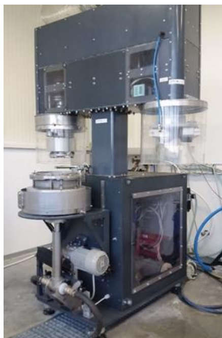
Obr. č. 9 Zařízení pro stanovení součinitele tření po ohlazení (vlevo), zkušební těleso z asfaltové směsi (vpravo)
