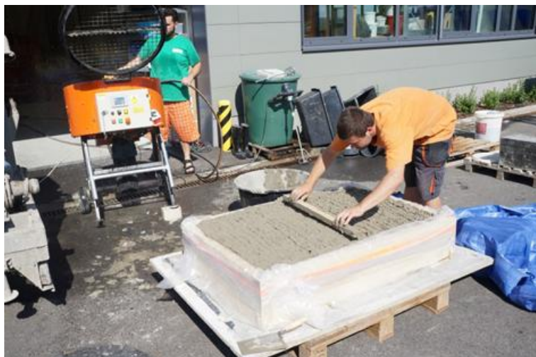
Obr. č. 1 Ověření technologie výroby tepelně izolačního kompozitu na cementové bázi v rámci projektu TH01030054
