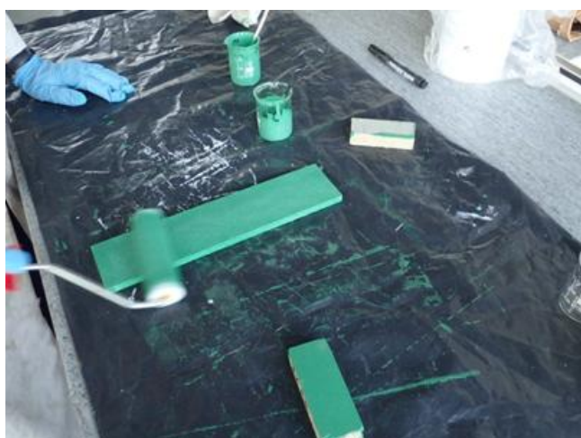
Obr. č. 2 Aplikace nátěru s alternativními strukturálními plnivými v rámci projektu TH01020282
