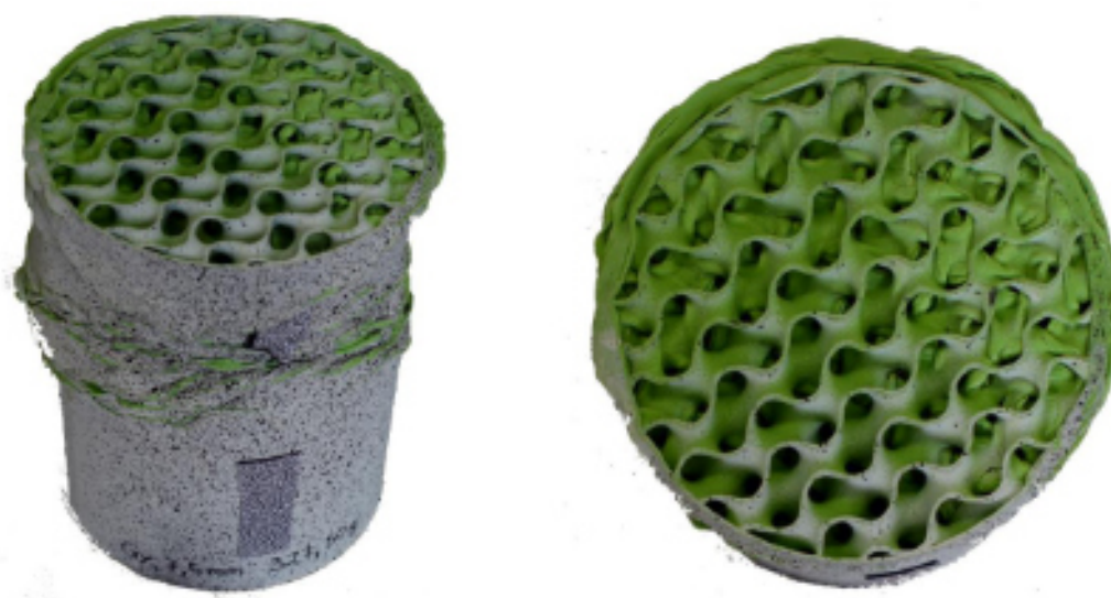
Obr. č. 48: Prostorový materiál – válec poškozený při tlakové zkoušce
