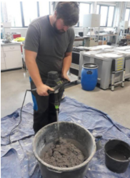
Obr. č. 14: Vývoj lehkých omítek z lehkého kameniva na bázi pěnového skla (spolupráce s firmou Refaglass)
