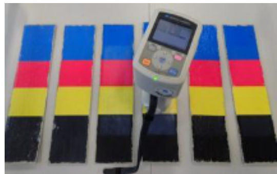
Obr. č. 9: Stanovení změn barevného odstínu po expozici v Q-Sun pomocí spektrofotometru
