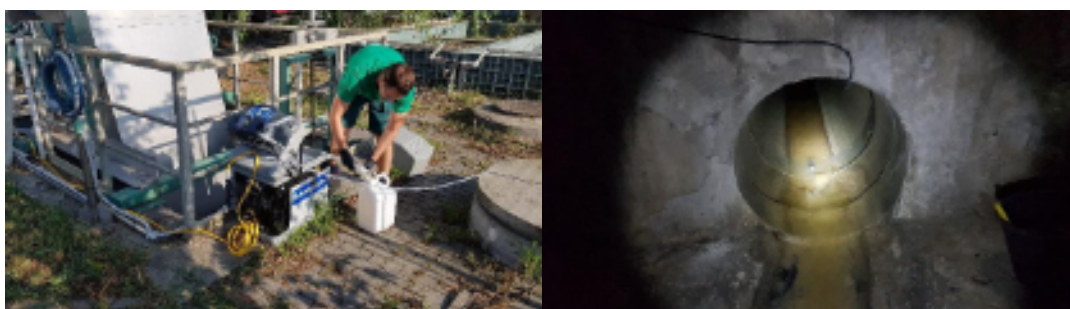
Obr. č. 33: Odběr vzorků z automatických vzorkovačů ISCO; měření průtoků na jednotné kanalizaci
