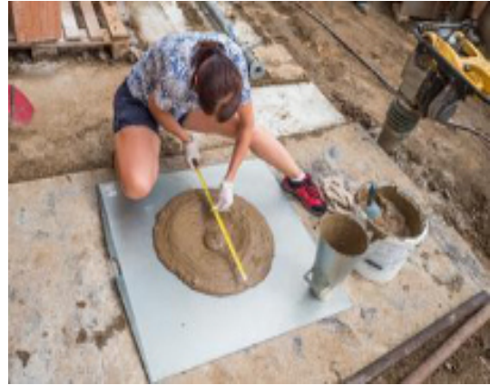
Obr. č. 5: Experimentální ověření ztekuceních zemin (měření rozlití pomocí MASH kužele)
