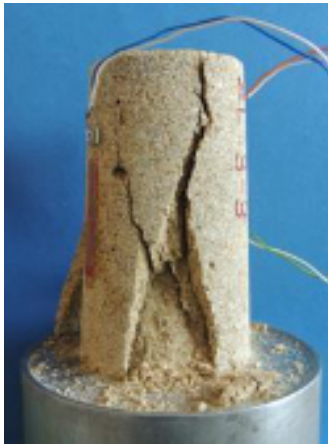
Obr. č. 29: Příklad pískovce s instalovanými odporovými tenzometry po porušení zkouškou v jednoosém tlaku
