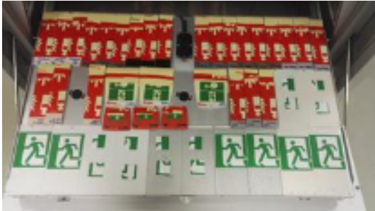
Obr. č. 10: Vzorky fotoluminiscenčních piktogramů v průběhu expozice v komoře Q–Sun
