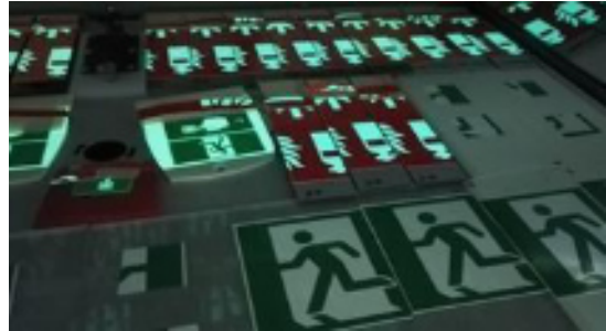
Obr. č. 11: Vzorky fotoluminiscenčních piktogramů v průběhu expozice v komoře Q–Sun
