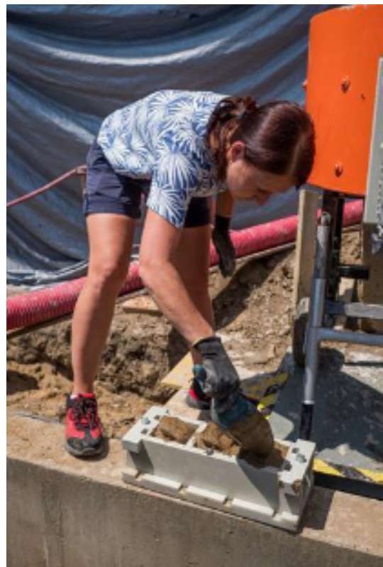
Obr. č. 7: Experimentální ověření ztekuceních zemin (odběr vzorků)
