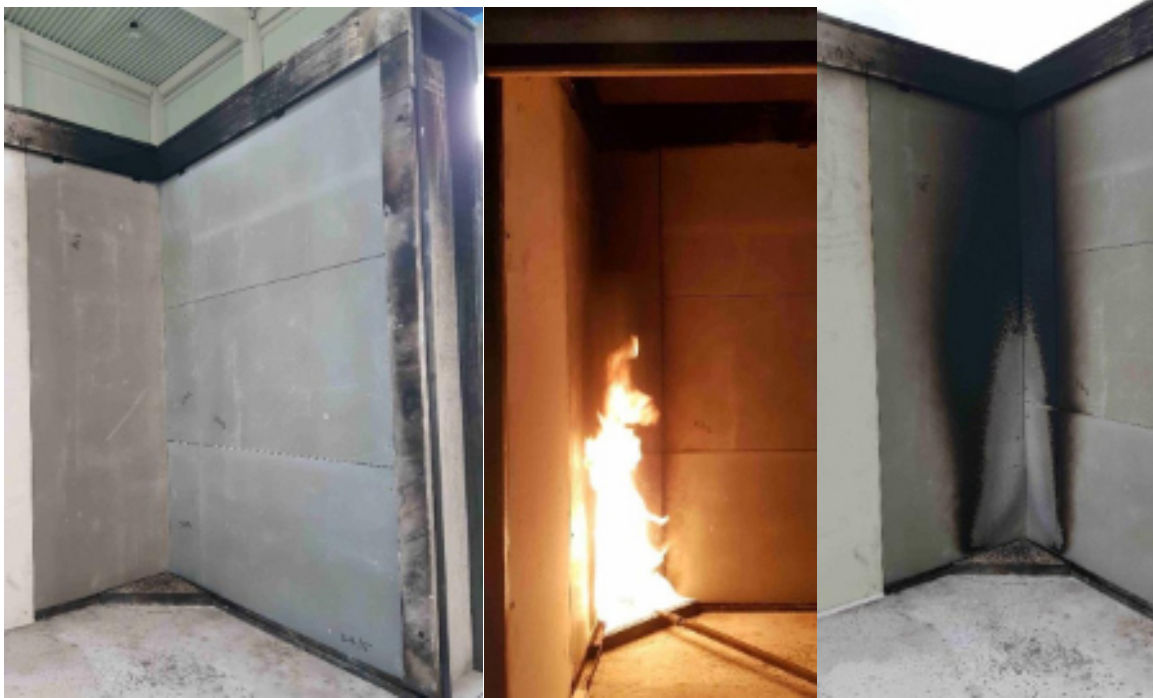
Obr. č. 15: Cementotřířskové desky při zkoušce stanovení reakce na oheň, působením jednotlivého hořícího předmětu. Zleva: zkušební vzorek instalovaný na vozík, vzorek během zkoušky, vzorek po zkoušce
