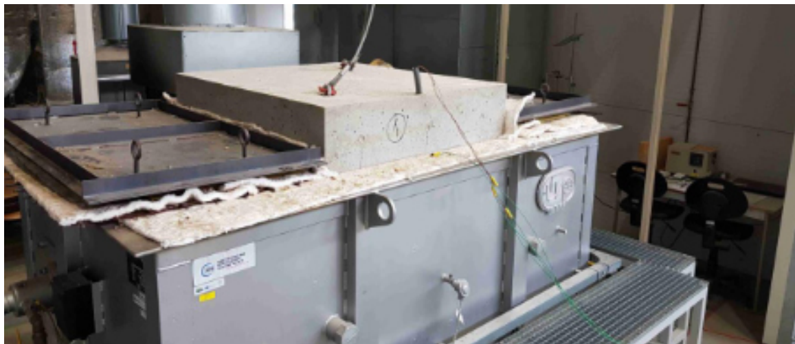
Obr. č. 16: Zkoušení požární odolnosti betonového segmentu s využitím polymerních vláken pro zvýšení požární odolnosti betonu, při izotermické výdrží 1 000 °C
