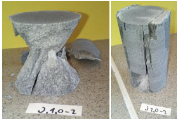
Obr. č. 30: Příklady vzorků droby po zkoušce v jednoosém tlaku. Testování bylo zaměřeno na ověření ovlivnění pevnosti horniny v tlaku v závislosti na poměru výšky k průměru tělesa ( L/D )
