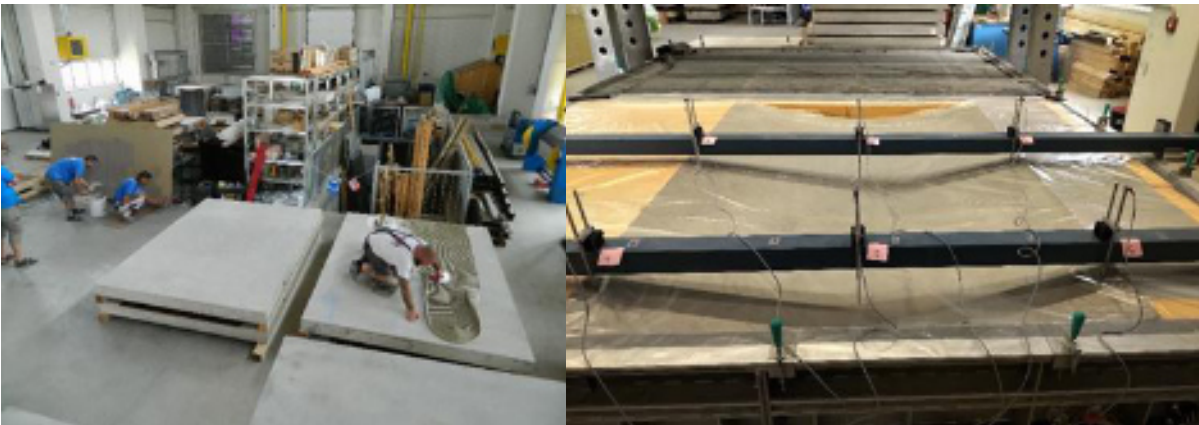
Obr. č. 26: a, Lepení velkoformátových keramických dlažeb na panely; b, Zkoušení keramických obkladů
