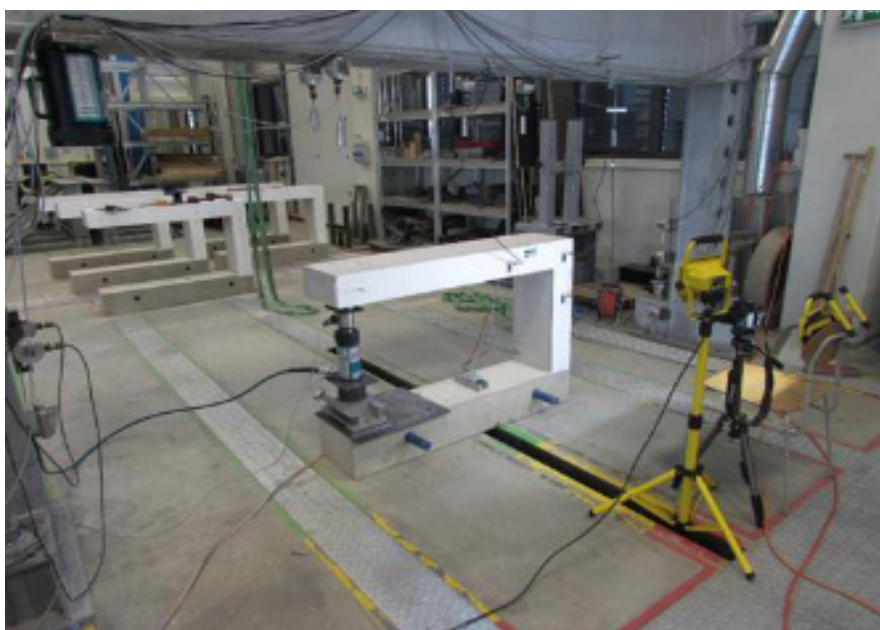
Obr. č. 21: Zatěžovací zkouška prvků rámových rohů
