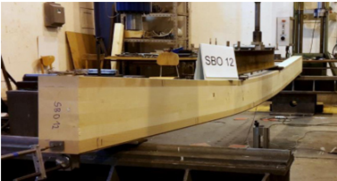
Obrázek 17: Ilustrace zatěžovacích zkoušek nosníků z lepeného lamelového dřeva s vyztužením ocelovým páskem
