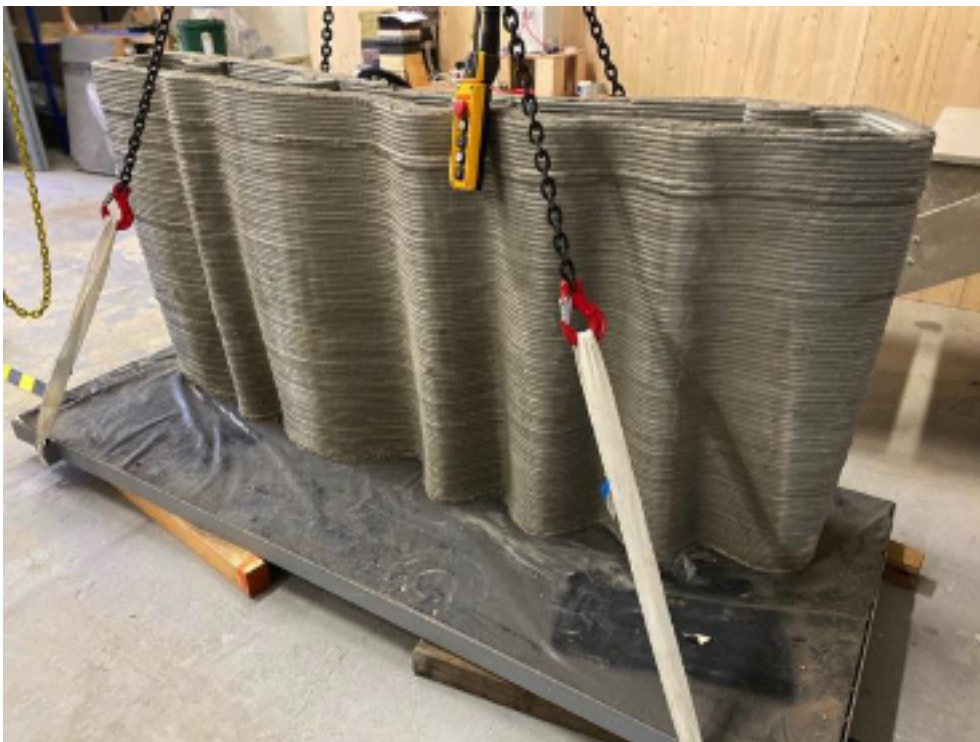
Obrázek 13: Ukázka možnosti 3D tisku na PST ve fullscale měřítku
