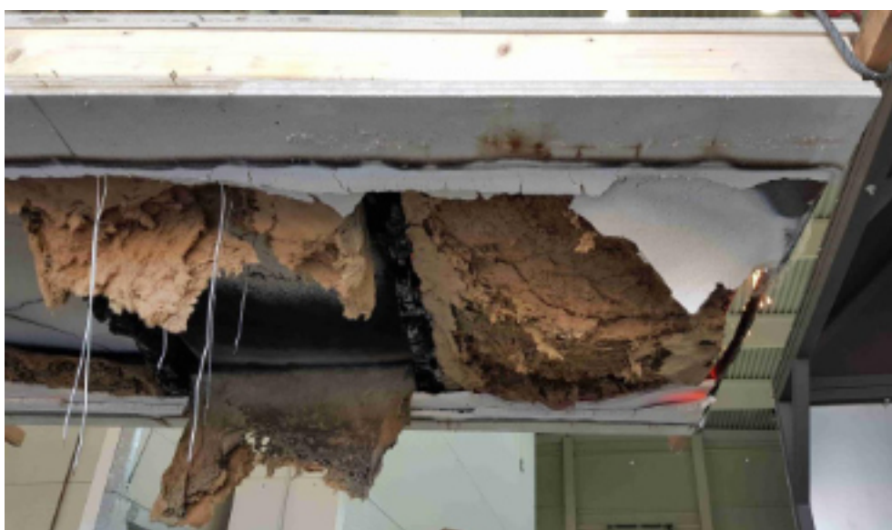
Obrázek 12: Zkoušení požární odolnosti dřevěné konstrukce, vhodné pro dřevostavby, s opláštěním ze sádkartonu, s vyšší teplotní odolností a s vloženou minerální tepelnou izolací; zkušební vzorek uložen na peci během zkoušky (nahore), vzorek po ukončení (dole)
