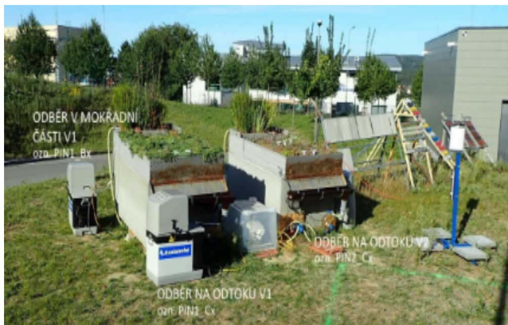
Obrázek 20: Automatické vzorkovače během testování kvality bílé vody během závlahy modulů zelených střech; lokalita AdMaS
