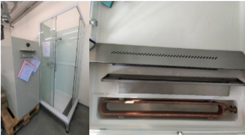
Obrázek 22: Horizontální výměník tepla ve sprchové vaničce na výzkumném Centru AdMaS VUT v Brně
