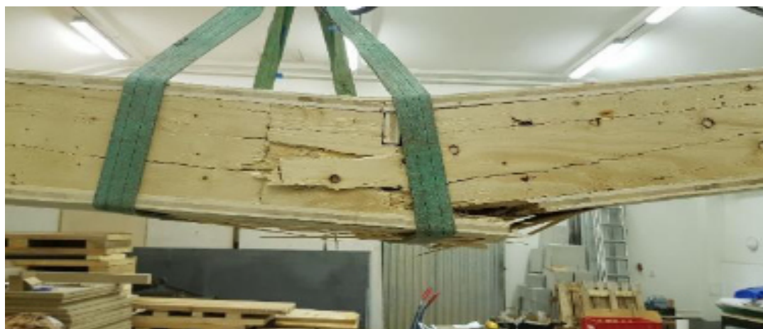
Obrázek 18: Detaily porušení zkušebního tělesa Eswp1 po provedení zatěžovací zkoušky čtyřbodovým ohybem a detail porušení zkušebního tělesa Elwl2 po provedení zatěžovací zkoušky vakuováním.
